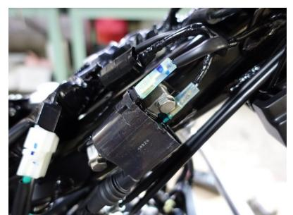
左上の状態まで外装を外します 上中央の写真が カバーを少し広げてコイルが見える状態です 黄色の中がイグニッションコイルです 右上の写真がノーマル状態のイグニッションコイルで 撮影のためカバーセット R メインパイプサイドとマフラーは外しています
