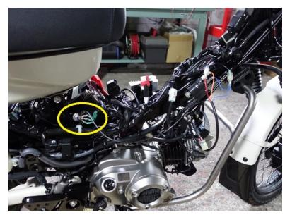
MSAdynamite 本体は アンダーカバーパイプに取り付けます 必ず配線の出口は内部に水の侵入を防ぐため下側にしてください
