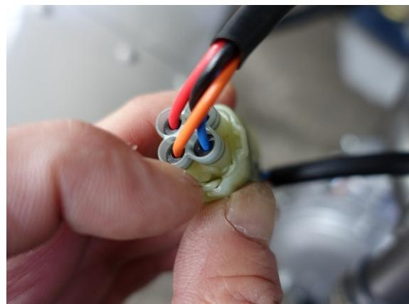
MSAdynamite を一時的に外したいとか 故障などでノーマル状態に復帰したい場合は 左上の写真のように 本体キットに付属のノーマル復帰カプラーと刺し替えることで ノーマル状態にすることが出来ます カプラーには簡単に抜けないように抜け止めの爪が有りますので 爪を右上の写真では 下方向に広げて抜いてください
