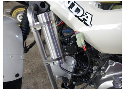
ブラケットには両面テープが貼り付けてありますので 本体に貼り付けて ガードパイプに保護用の透明チューブを被せて ホースバンドで締め付けて装着します
